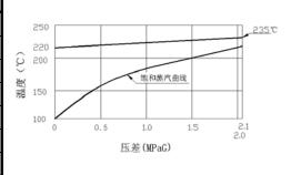
受外壳的设计条件(非工作条件): 最大允许压力(MPaG)PMA: 6.3 1MPa=10.197kg/cm<sup>2</sup>
